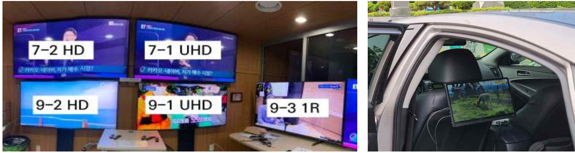
(그림 5-26) (좌) UHDTV로 고정 수신한 혁신 서비스 5개 전체 채널 (우) 차량 내 설치한 셋톱박스를 통해 수신 중인 '7-2 모바일 시범방송' 채널
