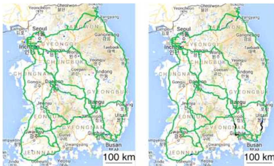
(그림 5-45) B-RTK(좌)와 VRS(우)의 이동 측위 결과
