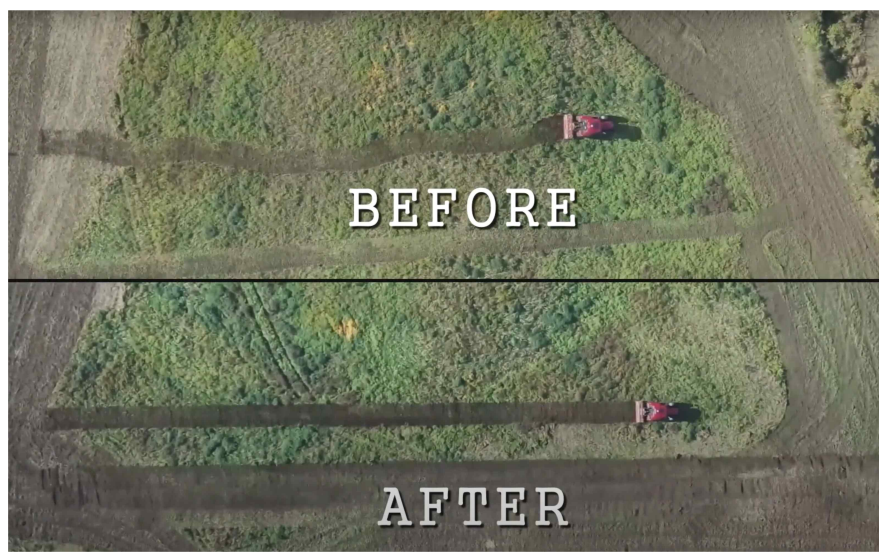
(그림 5-47) 지상파 UHD 방송망을 통한 RTK 서비스의 트랙터 경로 테스트
