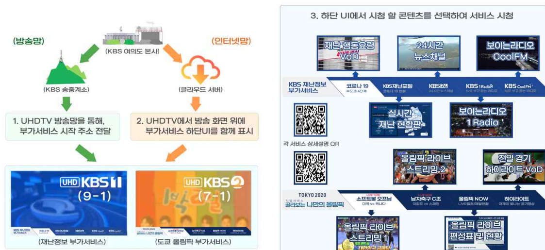
(그림 5-32) (좌) IBB 서비스 동작 흐름도 (우) KBS가 실제 운영 중인 IBB 메뉴 구성 사례
