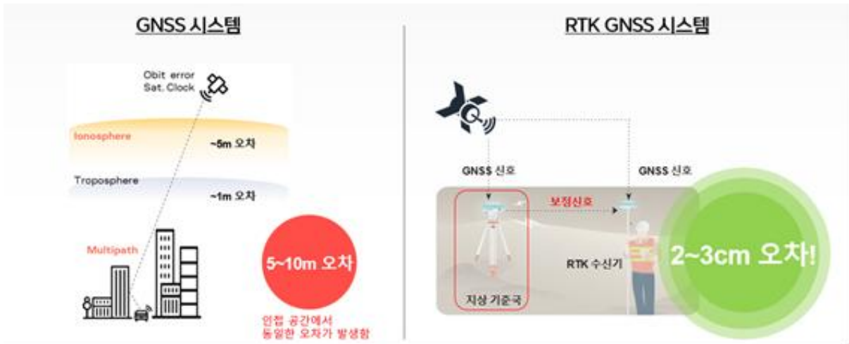
(그림 10-1) RTK 서비스의 기본 동작 원리
